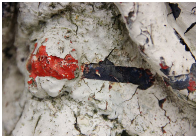
Obr. 4 Pásová sonda v oblasti pláště a růží, díky které bylo možné se zorientovat mezi jednotlivými fázemi barevných vrstev a jejich vzájemnou souvztažností. Foto: Michaela Burdová.
